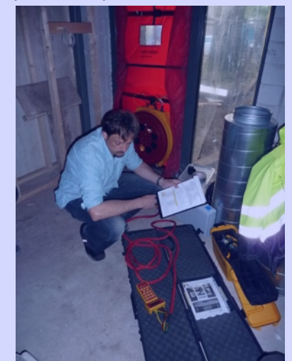
Blowertest eerste keer zeer luchtdicht: q_v; 10=0,05 \text{ dm}^3/\text{s}\cdot\text{m}^2
