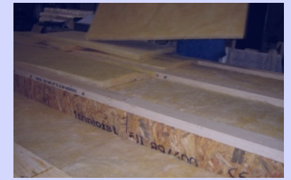
in fabriek houtskelet wand- en dakelementen vol isoleren
